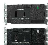
埋入式USB Power Delivery 智能快速充電插座2孔·開關組合 (USB-A+USB-C) (附螢光開關C) WTGF14746H (灰色) WTGF14746MB (霧黑) (輸入 AC 110 V 0.5 A 60 Hz) (單孔輸出 USB Type-A DC 5 V 3 A / 9 V 2 A) (單孔輸出 USB Type-C DC 5 V 3 A / 9 V 2 A / 12 V 1.5 A) (單孔最高輸出18 W) (雙孔合計輸出15 W) (螢光開關 15 A 110 V AC)
