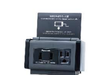
附保護蓋桌上型插座組合 (附手機放置機能) (充電用USB插座2孔·接地極插座) WKF1627H (灰色) (輸入 AC 110 V 0.3 A) (輸出 DC 5 V 合計2 A) (插座 15 A 125 V AC)
