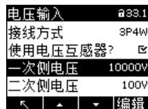
仅当设置“使用电压互感器”(USE PTs) 激活时，才能调节所使用的电压互感器比。
