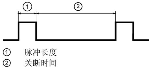
图 2-5 脉冲长度，关断时间
